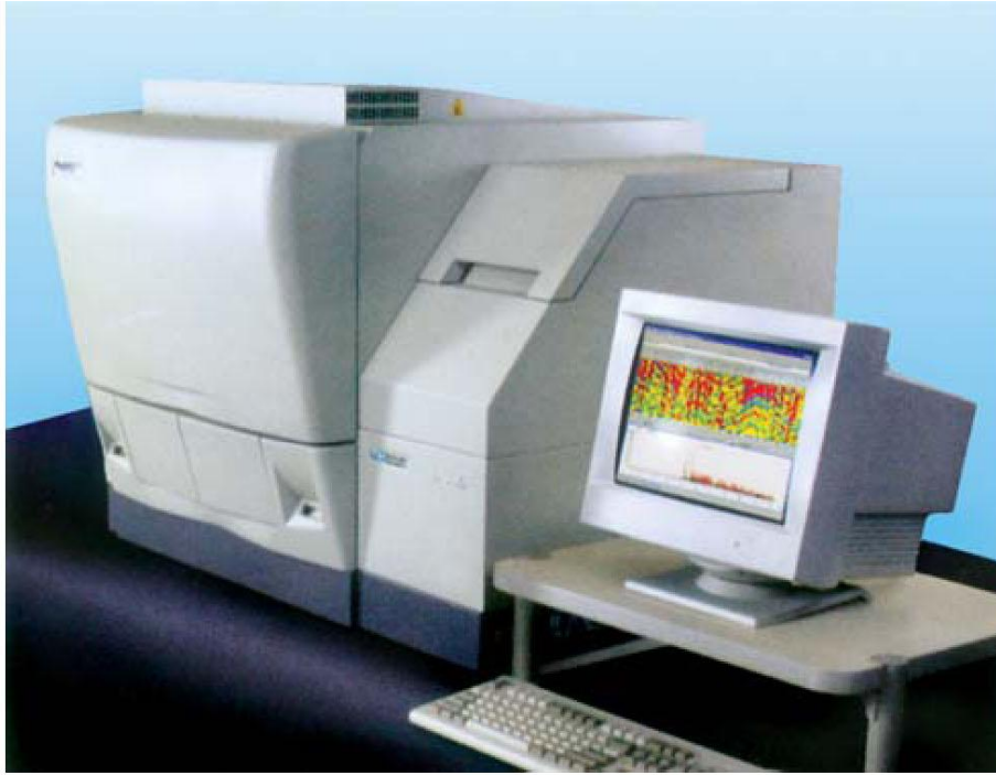
圖 5-49 核苷酸自動測序儀和測序譜圖 用於測定基因序列的儀器，可以大幅度提高測序速度和效率，加快基因測序工作的進程。左圖為核苷酸自動測序儀，高效率的儀器可以快速地測定DNA的序列。右圖為藉由自動測序儀測出的測序譜圖，每一條譜線表示一個DNA的基因序列，其精度已達相當高的水準。
